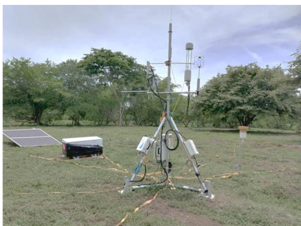
Tecnología del tipo Torre Eddy Covarianza de medición de flujos de gases, para cuantificar emisiones y absorción de gases en el ecosistema, y su relación con variables climáticas, así, reducir la incertidumbre en las estimaciones de las reservas y flujos de carbono.
