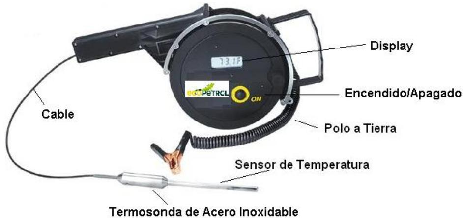
**Figura 3. Termómetro Electrónico Portátil.**
