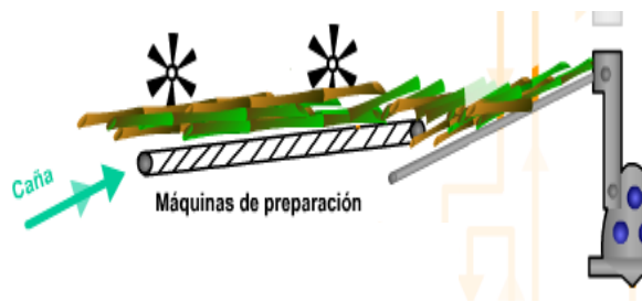
Gráfica 1: Proceso de Preparación de la Caña de Azúcar.
